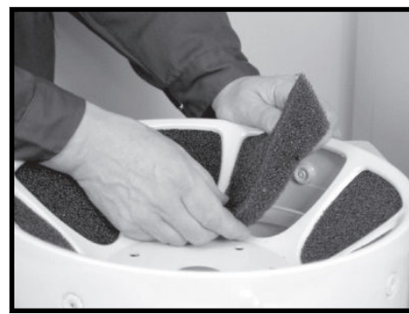
Steg 12. Ta bort gammal ljuddämpare och montera ny ljuddämpare.
